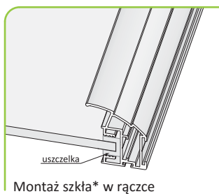
Montaż szkła* w rączce
